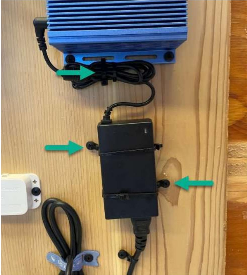
**良い例：電源やコードが抜けないようにACアダプタを壁に固定。温度の上昇を避けるためにそれぞれの機器に十分なスペースを確保。**
