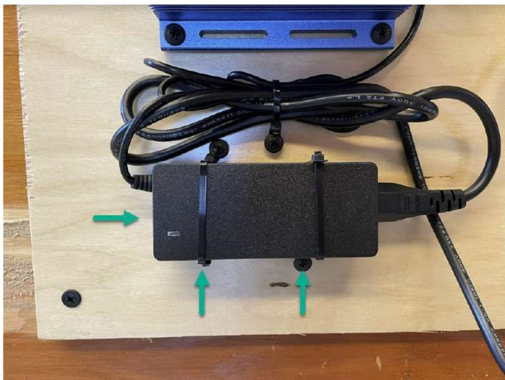
**良い例：電源コードが誤って抜けないようにジップタイやネジを使用してACアダプタを固定。**
