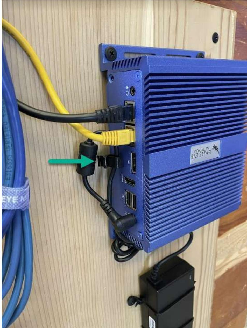
**良い例：電源コードが誤って抜けないように、付属のケーブルクリップを使用して電源コードをブリッジ/CMVRに固定。**
