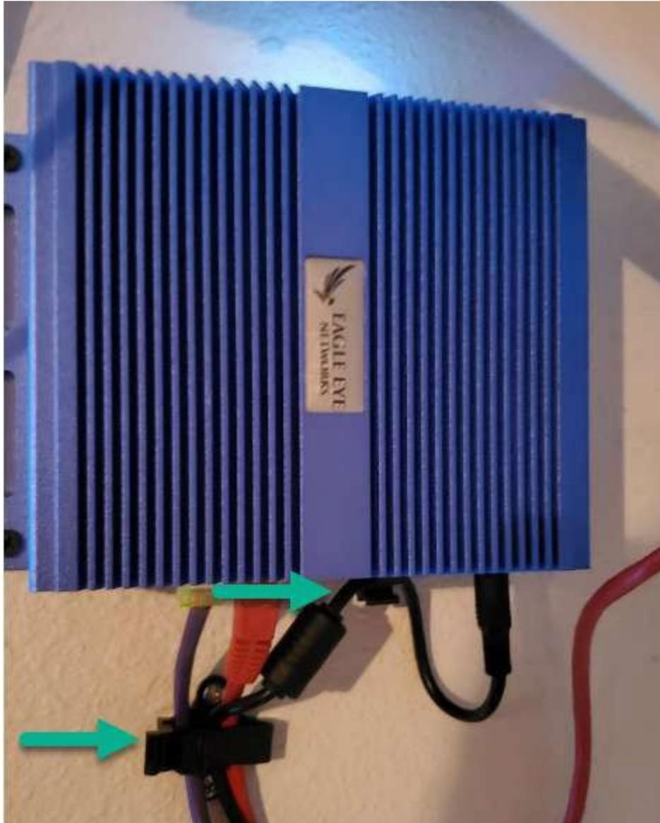
**良い例：時間が経過すると、ねじやマウントが緩みやすくなるため、コードやケーブルにストレインリリーフを付けて壁に固定。乾式壁には直接取付けない。**
