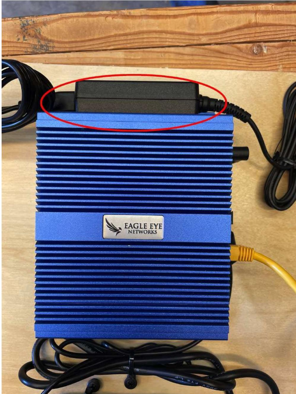
**不良例：ACアダプタがブリッジ/CMVRと接触して温度の上昇の原因になる。ブリッジ/CMVRの上には何も置かない。**
